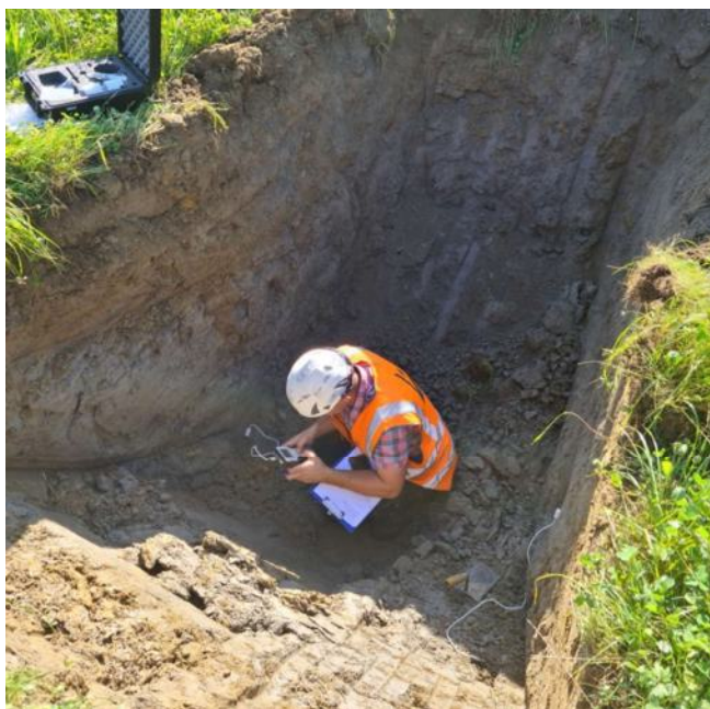
Slika 2: Meritev v sondažnem razkopu. (vir: IRGO Consulting d.o.o.)
