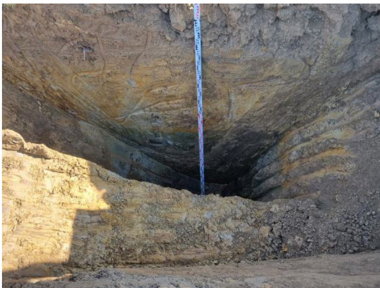
Slika 8: Opravljanje meritev z merilcem toplotne prevodnosti pri sondažnem razkopu KB-R2 (vir: IRGO Consulting d.o.o.)
