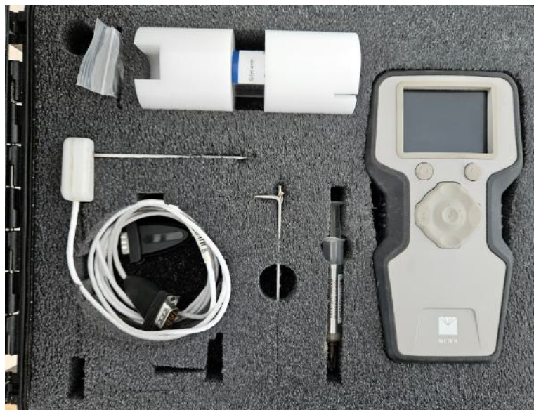
Slika 4: merilec toplotnih lastnosti Tempos (vir: IRGO Consulting d.o.o.)
