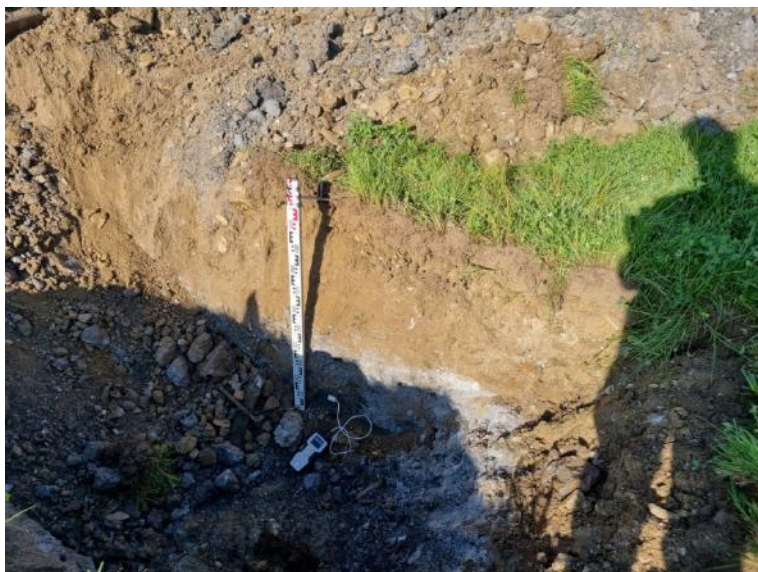
Slika 9: Opravljanje meritev z merilcem toplotne prevodnosti pri sondažnem razkopu KB-R3 (vir: IRGO Consulting d.o.o.)
