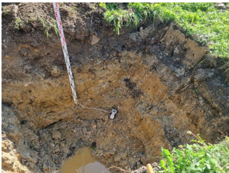
Slika 10: Opravljanje meritev z merilcem toplotne prevodnosti pri sondažnem razkopu KB-R4 (vir: IRGO Consulting d.o.o.)
