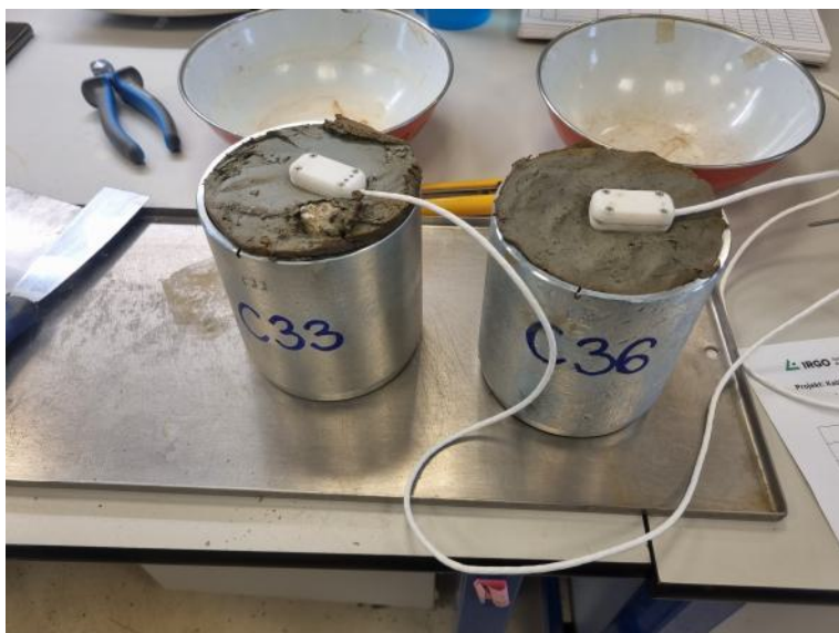
Slika 6: Opravljanje meritev toplotne upornosti v laboratoriju na vzorcih iz vrtin. (vir: IRGO Consulting d.o.o.)
